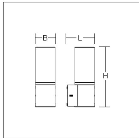
Decorativa luminaria de pared con un diseño innovador de la carcasa y óptica LED de alta calidad. Carcasa de aluminio inyectado revestido al polvo, resistente a la corrosión y al agua de mar. De serie con válvula protectora para evitar la condensación de agua. Fijación en la pared, fuera del área sellada con compensación de las desviaciones en el taladro. Se fija la luminaria sin tornillos, mediante el sistema RZB Gravo-lock®.
