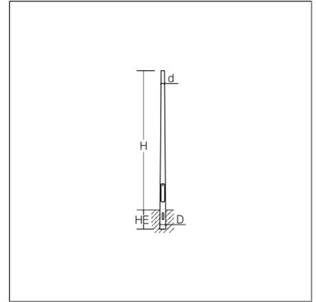
Konischer Lichtmast aus Stahl nach DIN EN 40. Feuerverzinkt nach DIN EN ISO 1461. Bündige Masttür, 85 x 400 mm. Türverschluss VA Dreikant, 10 mm Kantenlänge, M10 (andere Verschlüsse auf Anfrage). Gerüstesteg mit zwei Schiebemuttern M6 und Erdungsgewinde M8. Kabelloch 50 x 150 mm (UKK 500 mm unter Erde)
