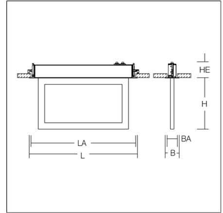
Leuchte zur Rettungswegkennzeichnung. Gehäuse Aluminium silberfarbig eloxiert. Displayscheibe mit patentierter MicroLens-Technik und Rettungszeichen einseitig. Betriebsgeräte integriert. Einzelbatteriesystem mit automatischem Selbsttest und Rückmeldung über DALI-Bus ausschließlich an das RZB DALI-Überwachungssystem. Symbolnummer für Rettungszeichen bei Bestellung angeben!
