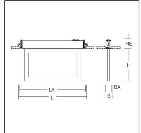
Luminaire pour la signalisation des voies d'évacuation. Corps en aluminium anodisé argent. Plaque display et technique de microlentille brevetée avec pictogramme de secours sur les deux faces. Appareillage intégré. Système de batterie autonome avec auto-test automatique et retour d'informations au système de surveillance RZB MULTIDIGIT. Merci d'indiquer le numéro de motif du pictogramme de secours lors de la commande
