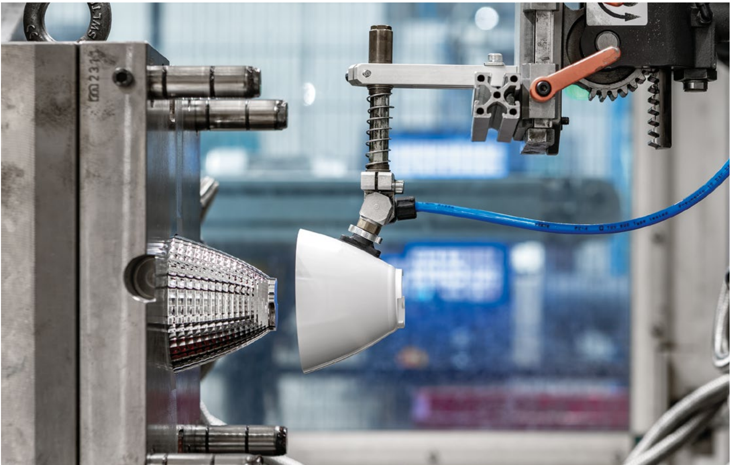
Hocheffiziente, gesputterte Spritzguss Reflektoren, designed und hergestellt von Zumtobel in Deutschland
