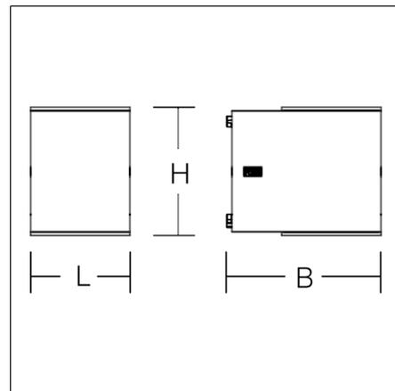
Wallscaping: Elegante und innovative Wandleuchte zur Akzentbeleuchtung. Gehäuse aus korrosionsbeständigem Aluminium-Druckguss, see-wasserbeständig pulverbeschichtet. Serienmäßig mit Membranventil zur Kondenswasser-Vermeidung. Abdeckung aus keramisch beschichtetem ESG mit Bajonettverschluss. Lichtaustritt nach unten, Wide flood. Wandbefestigung außerhalb des gedichteten Bereiches mit Bohrungstoleranzausgleich. Schraubenlose Leuchtenbefestigung mittels RZB Gravolock® System.
