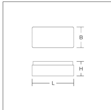
Luminaire apparent rectangulaire au design classique. Armature en matière synthétique. Verre opalin mat satiné, soufflage artisanal. Fixation du verre par système de ressorts. Convient à Montage des plafonniers, Flèche murale. IP 43 montage au plafond, IP 44 montage mural.
