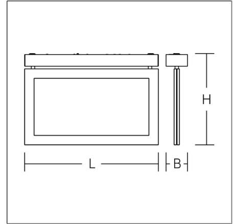
Leuchte zur Rettungswegkennzeichnung. Gehäuse Aluminium silberfarbig eloxiert. Displayscheibe mit patentierter MicroLens-Technik und Rettungszeichen zweiseitig. Betriebsgeräte integriert. Einzelbatteriesystem mit automatischem Selbsttest und Rückmeldung an das RZB Überwachungssystem MULTIDIGIT. Symbolnummer für Rettungszeichen bei Bestellung angeben!
