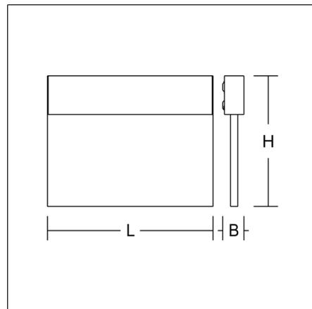
Luminaire pour la signalisation des voies d'évacuation. Corps en profilé d'aluminium extrudé, anodisé ou traité époxy. Plaque display en matière synthétique haute transparence avec pictogramme de secours simple face. Appareillage intégré. Convient pour le raccordement à l'alimentation centrale en électricité de secours. Merci d'indiquer le numéro de motif du pictogramme de secours lors de la commande
