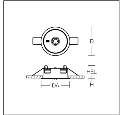
Rundes Einbau-Downlight. Zur Rettungswegbeleuchtung. Gehäuse Kunststoff (Polycarbonat). Abdeckung Kunststoff (Polycarbonat). Kunststofflinsen zur Flächen- und Rettungswegbeleuchtung im Lieferumfang enthalten. Geeignet für Deckenanbau, Deckeneinbau. Zum Anschluss an zentrale Sicherheitsstromversorgung geeignet.
