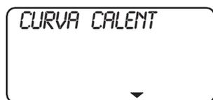
En la opción de menú CURVA CALENT podrá ajustar una **curva de calefacción** para el circuito de calefacción 1 y 2 respectivamente. Sólo con la curva de calefacción adecuada para el edificio correspondiente la temperatura de la habitación permanecerá constante a cualquier temperatura exterior. Por este motivo es sumamente importante elegir la curva de calefacción adecuada.
