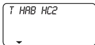
Con la opción de menú T HAB HC2 podrá ajustar para el circuito de calefacción 2 la **temperatura de referencia de la habitación** para el modo diurno y el de reducción. La **indicación de temperatura de la habitación 2 sólo aparecerá cuando el sensor de impulsión del mezclador esté conectado para el segundo circuito de calefacción.**
