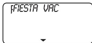
En la opción de menú Programación vacaciones el sistema de bombas de calor funcionará en modo de reducción. La función de protección antiescarcha para el depósito de ACS está activada.
