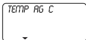
Mediante la opción de menú TEMP AG C podrá asignar un valor de referencia diurno y nocturno a la temperatura del depósito de ACS.
