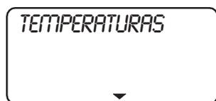
En la opción de menú TEMPERATURAS puede leer las **temperaturas de los sensores** de la bomba de calor o de la instalación con bomba de calor en comparación con los valores real y de referencia, **la distancia entre las curvas de calefacción, etc.**
