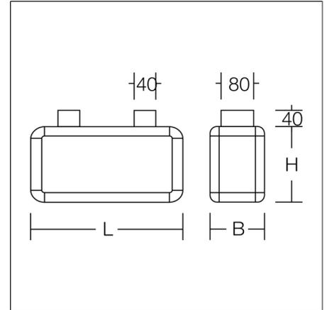
Rechteckige Anbauleuchte im klassischen Design. Zur Rettungswegkennzeichnung. Gehäuse Aluminium mit Eckverbindungen Kunststoff. Kunststoffscheiben opal mit Rettungszeichen einseitig/zweiseitig. Betriebsgerät integriert. Zum Anschluss an zentrale Sicherheitsstromversorgung geeignet. Mit Überwachungsbaustein AC-Control für LUXIFAIR Zentralbatterie-Anlagen. Symbolnummer für Rettungszeichen bei Bestellung angeben!
