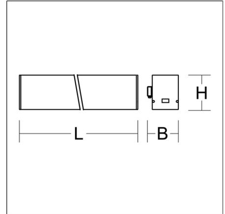
Lineare Wandleuchte. Gehäuse Aluminium-Strangpressprofil pulverbeschichtet. Endkappen Aluminium pulverbeschichtet. Diffusor aus vergilbungsfreiem Kunststoff (PMMA) opal. Lichtaustritt direkt. Geeignet für Wandanbau. Austauschbare und herausnehmbare LED-Einheit mit integriertem Betriebsgerät. Für Durchgangsverdrahtung geeignet. Auf Anfrage mit Sensorik oder als Sicherheitsleuchte.
