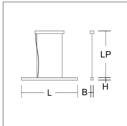
Pendelleuchte in minimalistischem Design. Gehäuse Aluminium-Strangpressprofil pulverbeschichtet. Endkappen Aluminium pulverbeschichtet. Diffusor aus vergilbungsfreiem Kunststoff (PMMA) mikroprismatisch. Lichtaustritt direkt 60%, indirekt 40%. Geeignet für Pendel. 2-Punkt Stahlseilabhangung stufenlos höhenverstellbar oder gewünschte Sonderlängen auf Anfrage. Betriebsgerät im Baldachin integriert.
