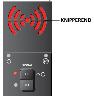
Afbeelding 3.1c: Zenderscherm met signaal in HOGE modus
