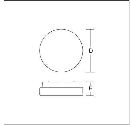
Dekorative runde Anbauleuchte. Armatur Kunststoff. Mundgeblasenes Drei-Schicht-Opalglass (Triplex-Glas) seidenmatt. Glasbefestigung mit Bajonettverschluss. Homogene und weiche Ausleuchtung.
