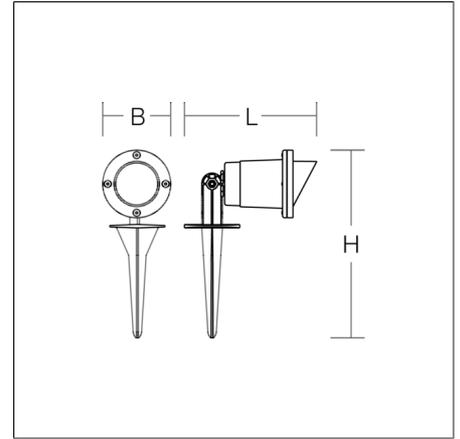
Proyector con pica para el suelo y protección antideslumbrante. Caja y protección antideslumbrante de aluminio inyectado, revestido al polvo. Difusor: vidrio de seguridad claro. Pica para el suelo de material sintético reforzado con fibras. LED directo a corriente, sustituible. Línea de conexión de 3 m con enchufe de seguridad.
