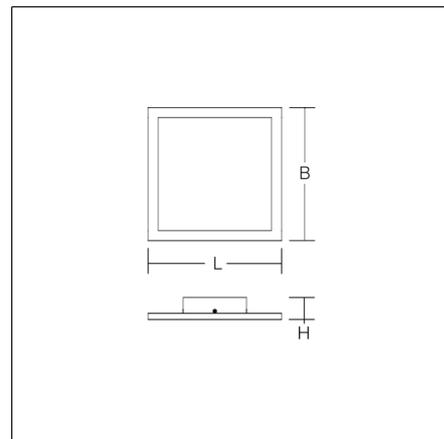
Luminaire de surface apparent hautement économique doté d'une technologie LED progressive. Cadre du luminaire en aluminium, traité époxy. Cadre de montage en tôle d'acier traité époxy. Diffuseur en matière synthétique opalin. Diffuseur et guide de lumière en plastique (PMMA) non jaunissant. Découplage lumineux latéral (technologie RZB SIDELITE®) pour une répartition incroyablement homogène de la densité de lumière.
