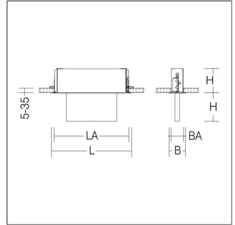
Luminaria para señalización de vías de evacuación. Caja empotrable de chapa de acero. Placa del techo de acero inoxidable brillante o revestido al polvo. Difusor display de material sintético transparente con símbolo gráfico de evacuación en una o dos caras. Equipo incluido. Sistema de emergencia autónoma con autotest. Número de artículo del motivo a especificar en el pedido!
