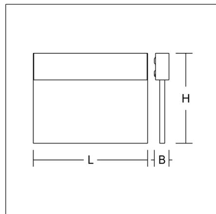
Luminaire pour la signalisation des voies d'évacuation. Corps en profilé d'aluminium extrudé, anodisé ou traité époxy. Plaque display en matière synthétique haute transparence avec pictogramme de secours simple face. Appareillage intégré. Système de batterie autonome avec auto-test automatique et retour d'informations au système de surveillance RZB MULTIDIGIT. Merci d'indiquer le numéro de motif du pictogramme de secours lors de la commande
