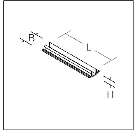
de material sintético. Cubierta del carril de corriente, longitud 1 m, cortable a medida. Para carriles de corriente trifásica y carriles RZB de corriente trifásica con DALI.
