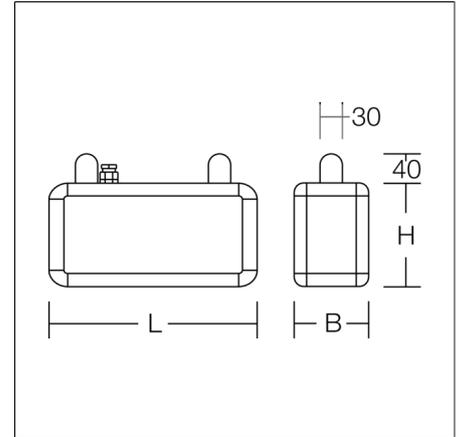
Rechteckige Pendelleuchte im klassischen Design. Zur Rettungswegkennzeichnung. Gehäuse Aluminium mit Eckverbindungen Kunststoff. Kunststoffscheiben opal mit Rettungszeichen einseitig/zweiseitig. Pendelleuchten (Pendel bauseits) für zwei Ketten- oder Seilpendel vorbereitet. Betriebsgeräte integriert. Einzelbatteriesystem mit automatischem Selbsttest und Rückmeldung an das RZB Überwachungssystem MULTIDIGIT. Symbolnummer für Rettungszeichen bei Bestellung angeben!
