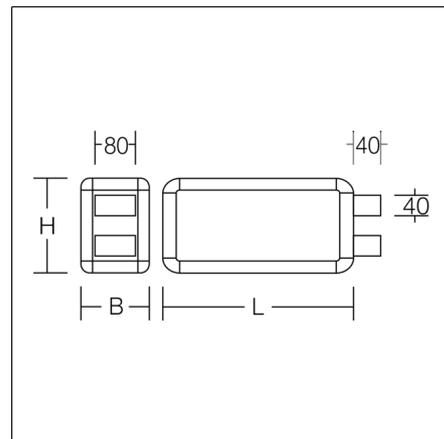
Applique sur console rectangulaire au design classique. Pour marquage de voies de secours. Corps en aluminium avec jonctions angulaires en matière synthétique. Plaques en matière synthétique opalines avec pictogramme de secours simple/double face. Etrier de fixation murale pour montage frontal Appareillage intégré. Système de batterie autonome avec auto-test automatique. Merci d'indiquer le numéro de motif du pictogramme de secours lors de la commande
