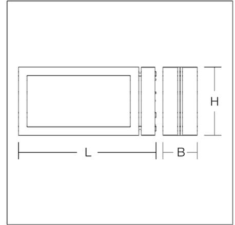
Leuchte zur Rettungswegkennzeichnung. Gehäuse Aluminium silberfarbig eloxiert. Displayscheibe mit patentierter MicroLens-Technik und Rettungszeichen einseitig. Wandbefestigungsbügel für stirnseitige Montage Betriebsgerät integriert. Zum Anschluss an zentrale Sicherheitsstromversorgung geeignet. Symbolnummer für Rettungszeichen bei Bestellung angeben!
