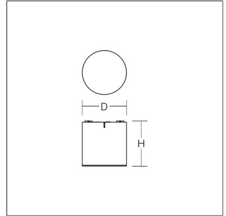
Hochwertiges Anbau-Downlight für Innen- und Außenbereich. Gehäuse aus korrosionsbeständigem Aluminium-Druckguss, seewasserbeständig pulverbeschichtet. Serienmäßig mit Membranventil zur Kondenswasservermeidung. Abdeckung Einscheiben-Sicherheitsglas (ESG) klar. Rotationssymmetrischer Reflektor aus reflexverstärktem MIRO-SILVER®. Einfache Montage durch separate Deckenarmatur und Steckverbindung. 5-polige Doppelklemme für Durchgangsverdrahtung.
