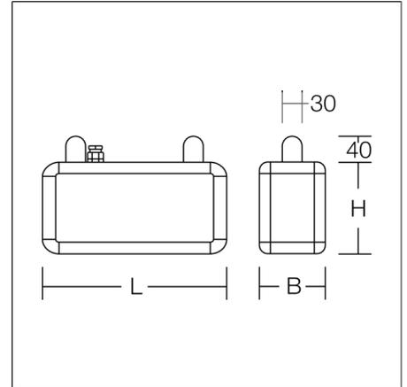
Luminaria de montaje en suspensión rectangular de diseño clásico. Para señalización de vías de evacuación. Carcasa de aluminio con uniones de esquina de material sintético. Difusores de material sintético opalino con símbolo gráfico de evacuación a una o dos caras. Luminarias para suspensión por dos cadenas o cables (suspensión a cargo del cliente). Equipo incluido. Sistema de emergencia autónoma con autotest. Número de artículo del motivo a especificar en el pedido!
