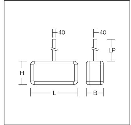
Rechteckige Pendelleuchte im klassischen Design. Zur Rettungswegkennzeichnung. Gehäuse Aluminium mit Eckverbindungen Kunststoff. Kunststoffscheiben opal mit Rettungszeichen einseitig/zweiseitig. Pendelabhängung Aluminium. Betriebsgerät integriert. Zum Anschluss an zentrale Sicherheitsstromversorgung geeignet. Mit Überwachungsbaustein AC-Control für LUXIFAIR Zentralbatterie-Anlagen. Symbolnummer für Rettungszeichen bei Bestellung angeben!
