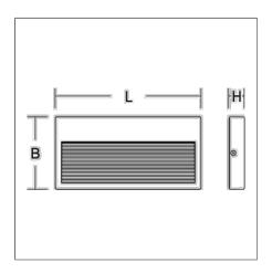
Flache Anbauleuchten mit LED zur wandnahen Beleuchtung von z.B. Treppenstufen, Rampen oder Gangzonen. Gehäuse aus korrosionsbeständigem Aluminium-Druckguss, pulverbeschichtet. Schrauben aus Edelstahl. Abdeckung mit klarem ESG. Asymmetrische nach unten gerichtete Lichtverteilung zur breitstreuenden und gleichmäßigen Beleuchtung. Mit Bohrloch-Toleranzausgleich. Betriebsgerät integriert. Mit Anschlussklemme bis  $1 \times 3 \times 1,5 \text{ mm}^2$ , für Netzleitung max. Ø 13 mm.
