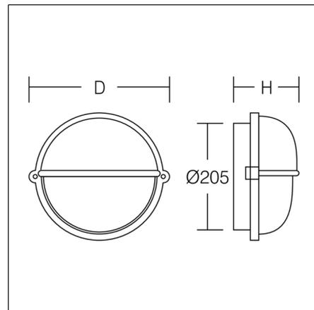
Robuste Wandleuchte für den Außenbereich. Armatur und Abdeckkappe Aluminium-Druckguss pulverbeschichtet. Mit Membranventil zur Vermeidung von Kondenswasser. Diffusor Kunststoff (Polycarbonat) opal. Befestigungsbügel Edelstahl mit Bohrloch-Toleranzausgleich. Netzanschluss 2 x 3 x 1,5 mm<sup>2</sup>.
