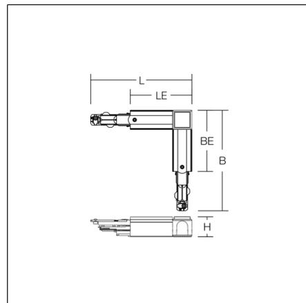
Jonction d'angle à 90° en matière synthétique, avec câble DALI 2 pôles supplémentaire intégré, câble d'alimentation 16 A / 400 V, ligne pilote DALI 2 x 1 A / 50 V FELV AC.
