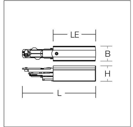
Alimentation en matière synthétique, avec câble DALI 2 pôles supplémentaire intégré, câble d'alimentation 16 A / 400 V, ligne pilote DALI 2 x 1 A / 50 V FELV AC.
