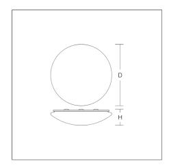
Dekorative runde Anbauleuchte. Armatur Metall pulverbeschichtet. Diffusor aus Kunststoff (Polycarbonat) opal, schlagzäh. Befestigung des Diffusors mit patentierter Verschlusstechnik (Druckverschluss). Geeignet für Deckenanbau, Wandanbau. Slaveleuchte. Nur in Verbindung mit entsprechender Masterleuchte zu betreiben.
