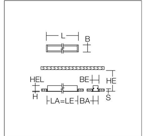
Decken- und Wandeinbauleuchte im minimalistischen Design. Gehäuse Aluminium-Strangpressprofil pulverbeschichtet. Endkappen Aluminium pulverbeschichtet. Aluminium-Mikroraster glänzend. Hervorragend geeignet für Bürobereiche ( $UGR \leq 19$ ) und Bildschirmarbeitsplätze (BAP) gem. DIN EN 12464-1. Geeignet für Deckeneinbau, Wandeinbau. Betriebsgerät extern mit Verbindungsleitung.
