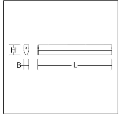
Luminaire apparent LED linéaire au design élégant. Armature en profilé filé d'aluminium, laqué. Embouts en aluminium, laqués. Diffuseur en matière synthétique opalin avec éclairage scintillant et brillant des lignes de l'ellipse. Convient à Montage des plafonniers, Flèche murale.
