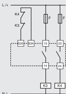
Circuit de rétroaction pour les contacteurs externes avec démarlage manuel ou contrôlé
