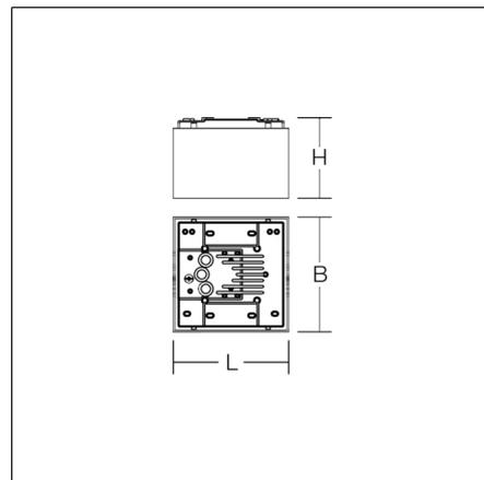
Leuchte zur Rettungswegkennzeichnung. Armatur Aluminium-Druckguss pulverbeschichtet Diffusor Kunststoff (PMMA) opal. 4 Folien zur Rettungswegkennzeichnung beigelegt (nach ISO 7010). Betriebsgeräte integriert. Einzelbatteriesystem mit automatischem Selbsttest und Rückmeldung an das RZB Überwachungssystem MULTIDIGIT. Durch Zubehör als Pendelleuchte montierbar.
