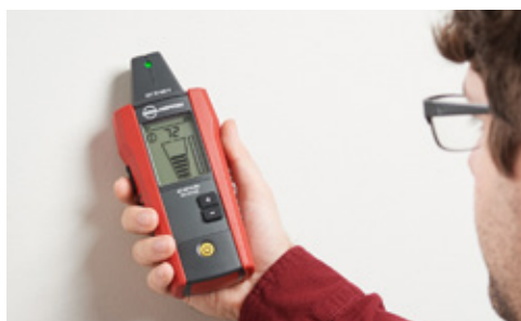
Spanningvoerende en spanningsloze kabels opsporen
