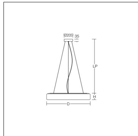
Dekorative runde LED Pendelleuchte. Armatur und Baldachin Metall pulverbeschichtet weiß. Baldachin Ø 205 mm, h 35 mm. Diffusor aus Kunststoff (Polycarbonat) opal, schlagzäh. Befestigung des Diffusors mit patentierter Verschlusstechnik (Druckverschluss). Homogene und weiche Ausleuchtung. Geeignet für Pendel. 3-Punkt Stahlseilabhängung stufenlos höhenverstellbar oder gewünschte Sonderlängen auf Anfrage.
