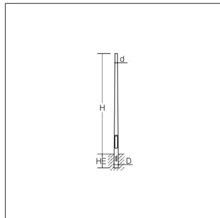
Poste cónico de acero. Galvanizado en caliente conforme a la normativa DIN EN ISO 1461. Puerta del poste montada a ras, 85 x 400 mm, conforme a la normativa DIN 48778, con enclavamiento triangular, a petición, con otro modo de cierre. Mallete con dos tuercas correderas y brida para tomatierra. Abertura para cables 50 x 150 mm en la pieza para empotrar en tierra.
