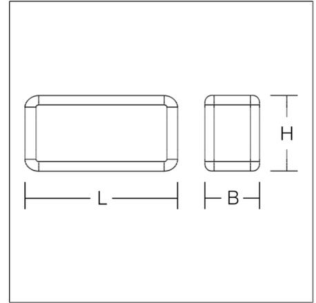
Leuchte zur Rettungswegkennzeichnung. Gehäuse Aluminium mit Eckverbindungen Kunststoff. Kunststoffscheibe opal mit Rettungszeichen einseitig. Betriebsgeräte integriert. Einzelbatteriesystem mit automatischem Selbsttest und Rückmeldung an das RZB Überwachungssystem MULTIDIGIT. Symbolnummer für Rettungszeichen bei Bestellung angeben!
