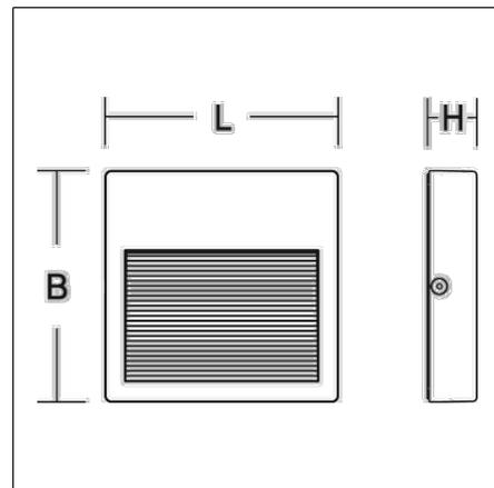
Luminaires apparents plats à LED pour l'éclairage en surface du mur, p. ex. sur des marches ou des couloirs. Corps en aluminium injecté résistant à la corrosion, traité époxy. Vis en inox. Diffuseur en verre ESG transparent. Distribution asymétrique de la lumière vers le bas pour un éclairage extensif et uniforme. Avec compensation de la tolérance du trou de perçage. Appareillage intégré. Avec bornier d'alimentation 1 x 3 x 1,5 mm<sup>2</sup>, avec section de câble Ø max. 13 mm.
