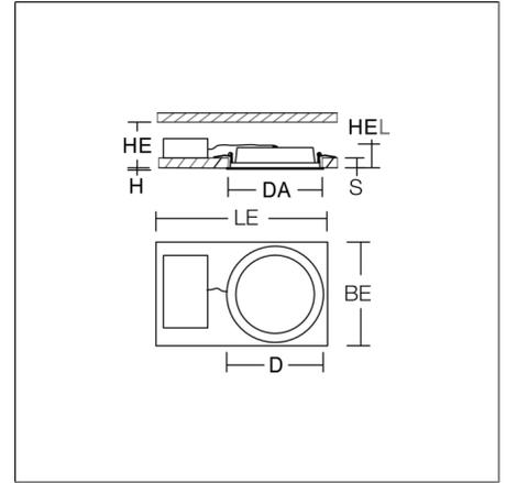
Flexibles rundes Einbau-Downlight mit Multi-Funktionen. Leuchte zur Rettungswegbeleuchtung. Gehäuse Stahlblech pulverbeschichtet. Leuchtenrahmen Aluminium pulverbeschichtet. Diffusor aus vergilbungsfreiem Kunststoff (PMMA) opal. LED Backlight-Technologie für eine homogene Ausleuchtung der gesamten lichtabgebenden Fläche. Deckenbefestigung mit Federsystem. Inklusive Betriebsgerät extern über Steckverbindung, Verbindungsleitung 250 mm.
