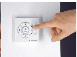
Nun werden die passenden Sensoren und Bediengeräte am Control-In des DIMLITE Basismoduls angeschlossen. Ein zusätzliches Gerät im Schaltschrank ist nicht notwendig, sondern... ... das Basisgerät initialisiert sich in wenigen Sekunden selbst. Die grüne LED zeigt den betriebsbereiten Zustand der Anlage an. So funktioniert "Plug & Play" im besten Sinn des Wortes.
