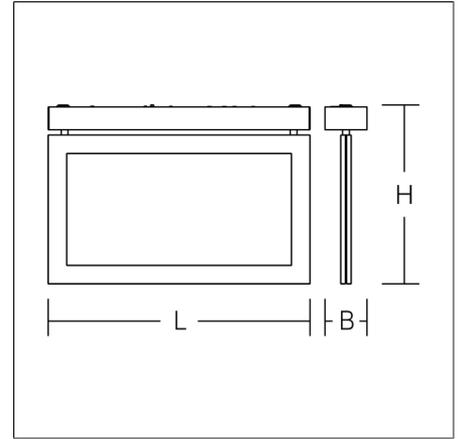
Luminaria para señalización de vías de evacuación. Carcasa de aluminio, anodizado en plateado. Difusor display con la técnica MicroLens patentada con símbolo gráfico de evacuación a dos caras. Equipo incluido. Sistema de emergencia autónoma con autotest. Número de artículo del motivo a especificar en el pedido!
