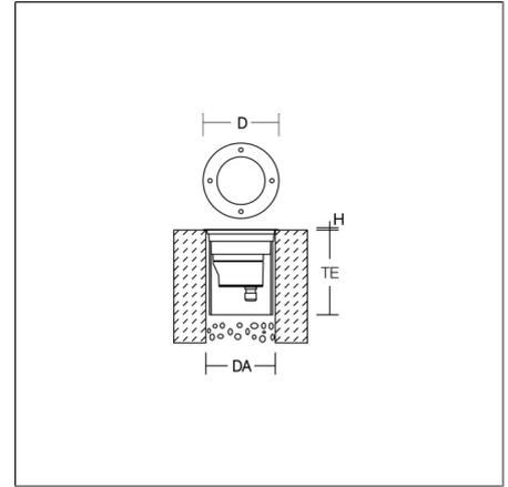
Bodeneinbauleuchte für Fußgängerbereiche. Gehäuse aus korrosionsbeständigem Aluminium-Druckguss, pulverbeschichtet. Schrauben und kreisförmige Abschlussblende Edelstahl V4A. Bündige ESG-Verglasung. Hochleistungs-LED-Refraktoroptik. Lichtrichtung bis 10° aus der Vertikalen einstellbar. Mit Anschlussleitung H07-RN8F. Die Verwendung eines Einbaugesäuses ist erforderlich, bitte bestellen Sie separat die passende Ausführung.
