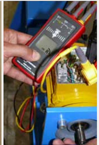
Controle van motorrotatie voorafgaand aan aansluiting
