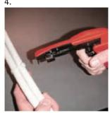
Abschneiden des Kabelbinders, durch zudrücken der Kabelbinderzange!
