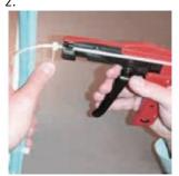
Zuziehen des Kabelbinder mit der Kabelbinderzange!
