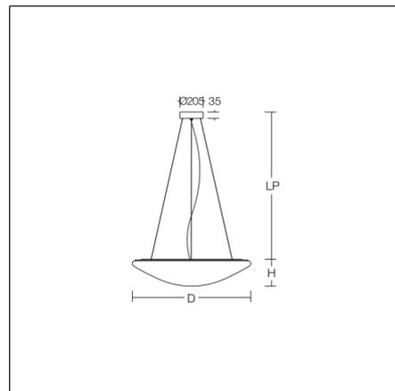
Dekorative runde LED Pendelleuchte. Armatur und Baldachin Metall pulverbeschichtet weiß. Baldachin Ø 205 mm, h 35 mm. Diffusor aus Kunststoff (Polycarbonat) opal, schlagzäh. Befestigung des Diffusors mit patentierter Verschlusstechnik (Druckverschluss). Geeignet für Pendel. 3-Punkt Stahlseilabhängung stufenlos höhenverstellbar oder gewünschte Sonderlängen auf Anfrage. TouchDim Sensor fähig. Sensoren für Helligkeit und/oder Anwesenheit können mit eingebunden werden.
