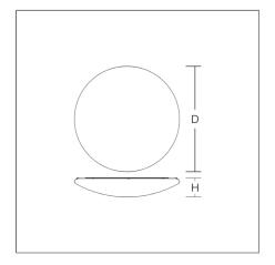
Decorativa luminaria redonda de montaje en superficie. Para iluminación de emergencia. Base de metal revestido al polvo. Difusor de material sintético opalino (PMMA) que no amarillea. Sujeción del difusor con mecanismo de cierre patentado (cierre a presión). Apto para Montaje en superficie de techos, Montaje en superficie de la pared. Equipo incluido. Sistema de emergencia autónoma con autotest.
