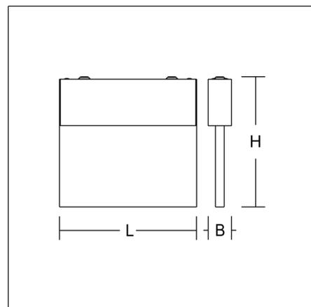
Luminaire pour la signalisation des voies d'évacuation. Corps en profilé d'aluminium extrudé, anodisé ou traité époxy. Plaque display en matière synthétique haute transparence avec pictogramme de secours simple/double face. Appareillage intégré. Convient pour le raccordement à l'alimentation centrale en électricité de secours. Merci d'indiquer le numéro de motif du pictogramme de secours lors de la commande
